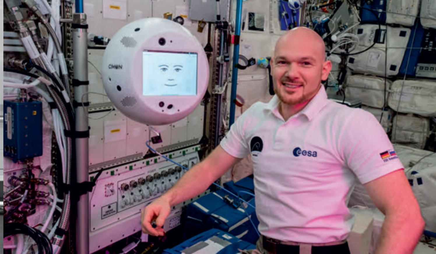
Der in Deutschland entwickelte und gebaute Astronauten-Assistent CIMON hat seine Feuertaufe im All bestanden. Der deutsche ESA-Astronaut Alexander Gerst arbeitet mit ihm im November 2018 rund 90 Minuten im Columbus-Modul der Internationalen Raumstation ISS. Die fünf Kilogramm schwere, 3-D-gedruckte Kunststoffkugel ist der erste mit Künstlicher Intelligenz ausgestattete Astronauten-Assistent im Weltraum.
