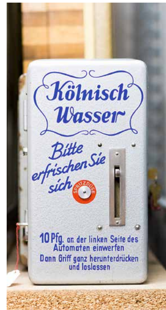
Verkaufsautomat „Kölnisch Wasser“ von 1960: Wird nach Einwurf einer Münze der Hebel rechts neben der Düse betätigt, so wird der Käufer mit Kölnisch Wasser erfrischt.
